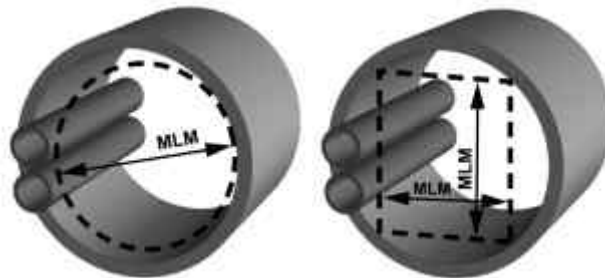
Abb. 6: Mindestlichtmaß (MLM) von Verkehrswegen in Tunneln, Stollen und Durchpressungen
